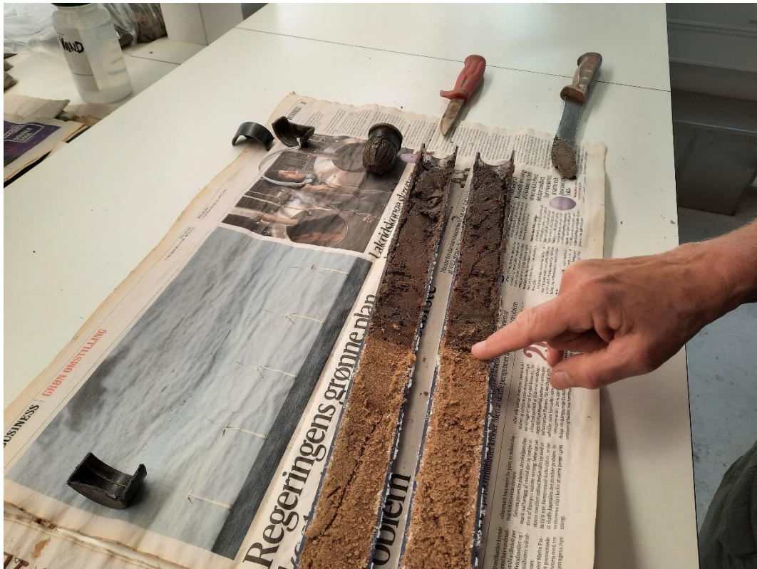
Figur 18: Den opskårne kerne fra boringen i Tisvilde Hegn, hvor den skarpe grænse mellem muldlaget og flyvesandsdækket træder tydeligt frem.
