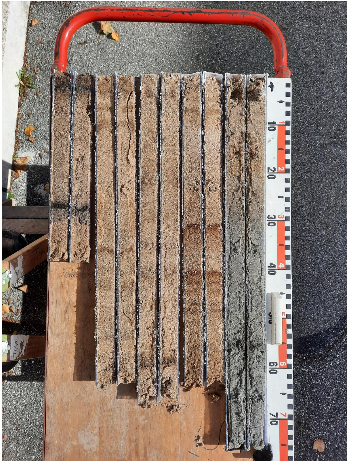
Figur 23: De opskårne kerner fra boringen på Melby Overdrev. Øverst til venstre er terrænoverfladen og kernen længst til højre er marint sand nederst i boringen.
