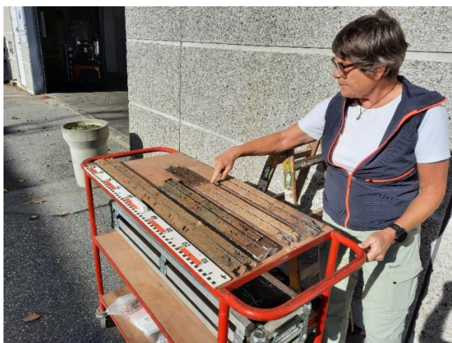
Figur 17: De opskårne kerner fra boringen i Tisvilde Hegn. Øverst til venstre i det øverste foto er terrænoverfladen og kernen længst til højre er moræneleret nederst i boringen. På det nederste foto peges der på overgangen mellem muldlaget og flyvesandsdækket. Den samme overgang, men set lidt tættere på, udpeges på foto, Figur 18.
