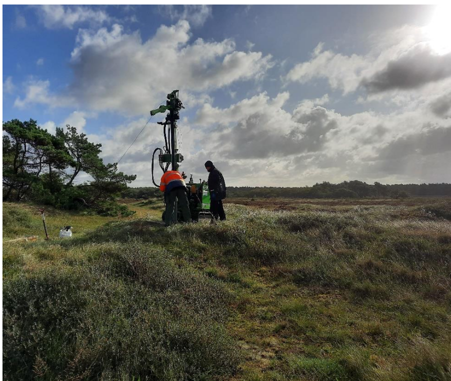
Figur 20: Melby Overdrev. Boring er påbegyndt gennem klit lige ved siden af det spor, georadaren kørte i, markeret ved skovlen til venstre.
