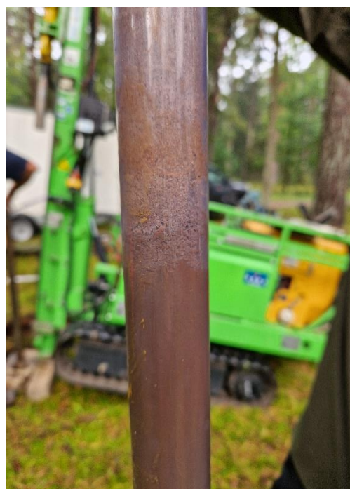
Figur 15: Boring i Tisvilde Hegn. Øverst: En kerne er ved at blive trukket op. Der bores 1 meter ad gangen. Nederst til venstre: 1 meter/kerne nr. 2 møder vi overgangen mellem muldlaget (brunt) og flyvesandet (lysere), der fæg ind på markerne og efterhånden umuliggjorde dyrkning af noget som helst. Nederst til højre: nærbillede af overgang mellem muld og flyvesand.
