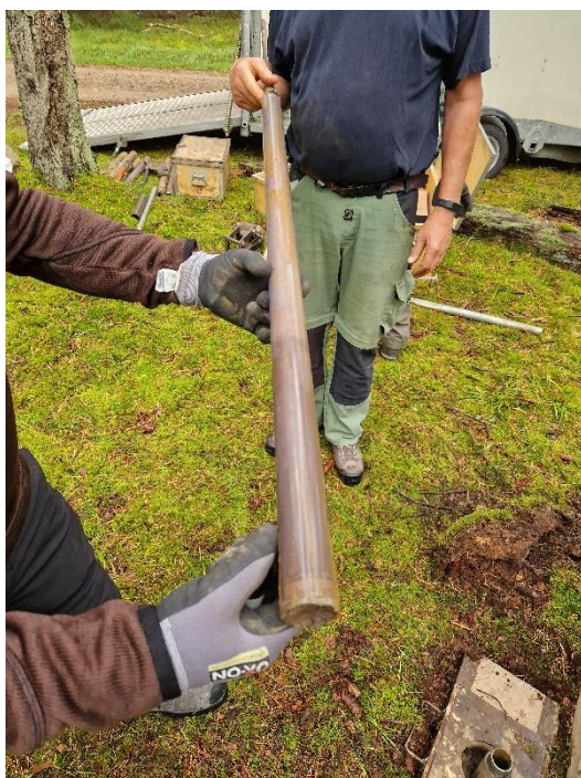
Figur 15: Boring i Tisvilde Hegn. Øverst: En kerne er ved at blive trukket op. Der bores 1 meter ad gangen. Nederst til venstre: 1 meter/kerne nr. 2 møder vi overgangen mellem muldlaget (brunt) og flyvesandet (lysere), der fæg ind på markerne og efterhånden umuliggjorde dyrkning af noget som helst. Nederst til højre: nærbillede af overgang mellem muld og flyvesand.
