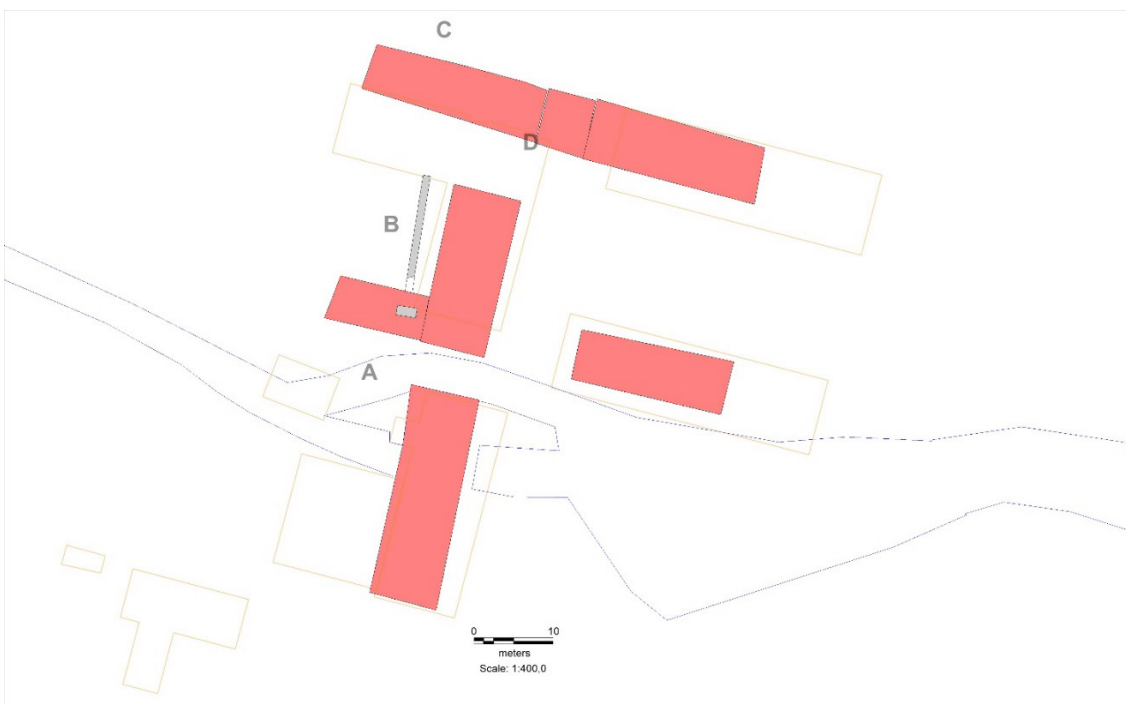
Fig. 31.b Oversigt over bygninger ved Esrum Mølle. Rød: bygninger og blå streg angiver Esrum Å. Tegnet på baggrund af kort fra 1806. Lysebrunt omrids angiver nuværende bygninger. A) Omløb, der i dag er sløjket, B) Bygningsrester, der blev registeret af C. M. Smidt i 1935, C) Bygning, der i dag er nedrevet, D) Portbygning. Udarbejdet af forfatteren.
